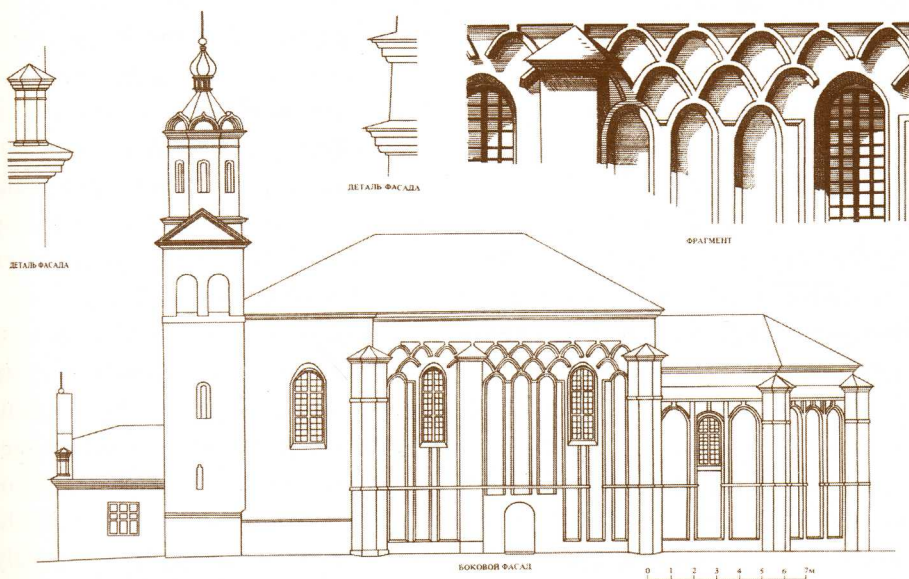
Ilustracja 6. Nowogródek. Cerkiew św. Borysa i Gleba, pocz. XVI w. Zewnętrzne ściany dekorują gotyckie nisze arkadkowe, wewnątrz bogate gotyckie sklepienia. Atlas pamjatnikov architektury i memorial'nych kompleksov Belorussii, red. V. A. Čanturija, Minsk 1988, tab. 3, s. 27.
