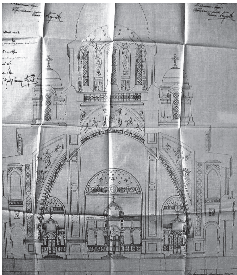
Rys. 6. Przekrój poprzeczny soboru Zmartwychwstania Pańskiego w Białymstoku wg projektu Doncowa 31
