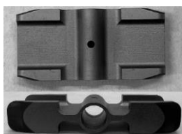
Rysunek 29. Zdjęcia przedstawiające rodzaje stosowanych rurek grafitowych: A) zwykła rurka grafitowa i B) rurka grafitowa z platformą.
