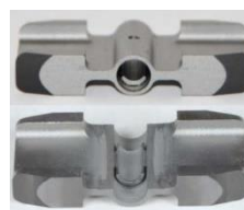
Rysunek 29. Zdjęcia przedstawiające rodzaje stosowanych rurek grafitowych: A) zwykła rurka grafitowa i B) rurka grafitowa z platformą.
