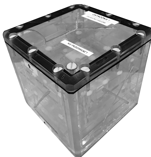
Rys.38 Akwarium z tworzywa sztucznego, w którym umieszczany jest fantom do badania rozdzielczości przestrzennej obrazów tensora dyfuzji. Jest to sześcian o boku ok 20 \text{ cm} .
