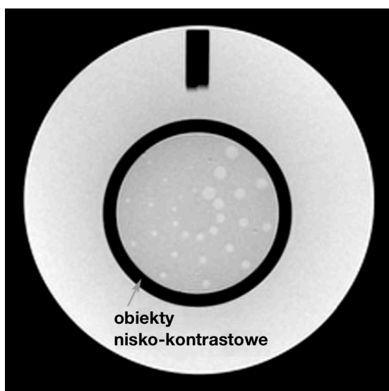
Rys.34 Prawidłowy obraz jedenastej warstwy fantomu ACR , w której widoczne są obiekty nisko-kontrastowe w postaci nieco jaśniejszych kropek ustawionych na kształt szprych w kole rowerowym. Obrazek zaczerpnięty z [135].
