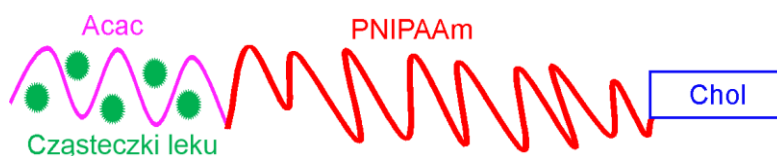
Schemat 5. Budowa polimerowego nośnika leku z podziałem na część kompleksującą, część termowrażliwą i część naprowadzającą.
