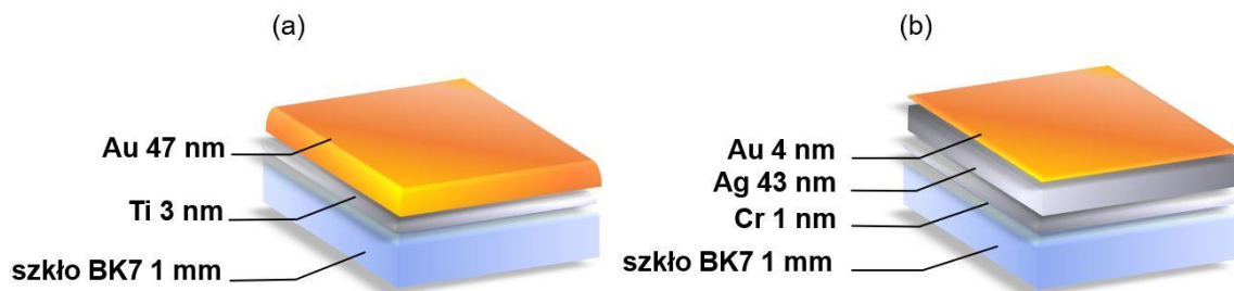
Rys. 36. Schemat struktury chipów: (a) chip Au, (b) chip Ag/Au. Opracowanie własne.
