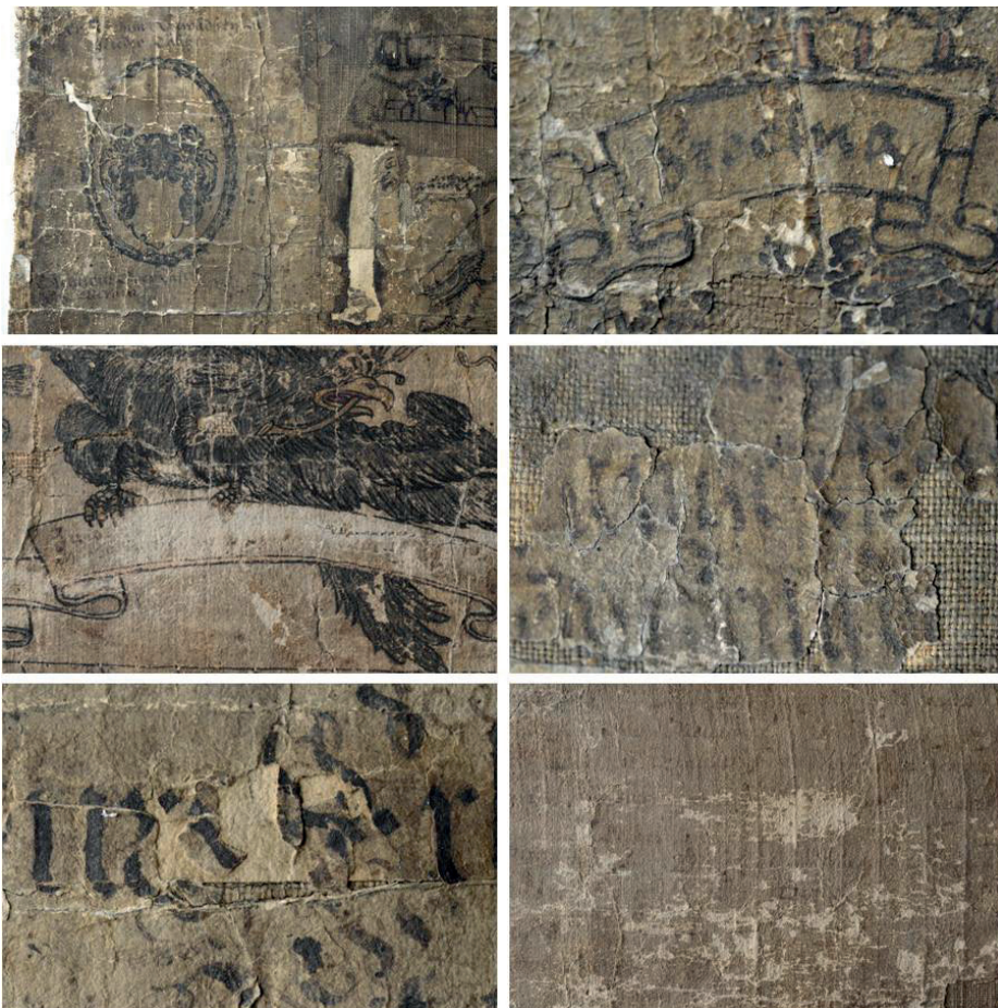
Ryc. 6. Zbliżenia fragmentów mapy obrazujących przykładowe zniszczenia tekstów: (od lewej) wysoce zaawansowana destrukcja podłoża, aż do jego perforacji, spowodowana korozją atramentów żelazowo-garbnikowych, nawarstwienia wtórnie wprowadzonych na powierzchnię spoiw, mechaniczne przetarcia tekstu i blaknięcie, uszkodzenia mechaniczne – ubytki i wykruszenia podłoża wraz z tekstem, przesunięcia luźnych fragmentów, blaknięcie tekstów atramentów w kartuszkach (fot. Jolanta Czuczko)
